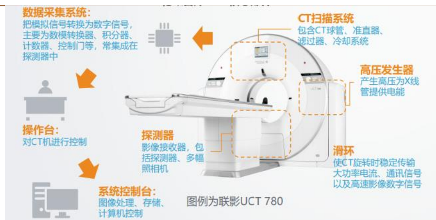
图 48：CT 主要构成示意图
